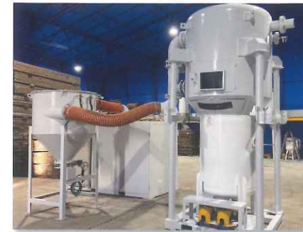
大型 TYPE / 55 kw 施工延長 300m
