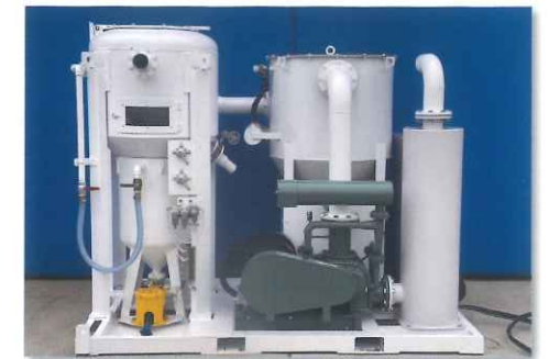
小型 TYPE / 22 kw 施工延長 100m
